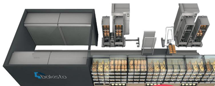
Die KI des **BakeOff-Moduls** von Wanzl ist in der Lage, zu berechnen, wie viele Backwaren für den momentanen Abverkauf vorbereitet werden müssen. Auf Basis dieser Daten entnimmt der **Cobot** die mit tiefgekühlten Backwaren bestückten Bleche aus dem Kühlsystem und überführt sie in das Beschickungssystem. Von hier an übernimmt das automatische Beschickungssystem **TrayMotion** von **WIESHEU**. Dieses zieht die beladenen
